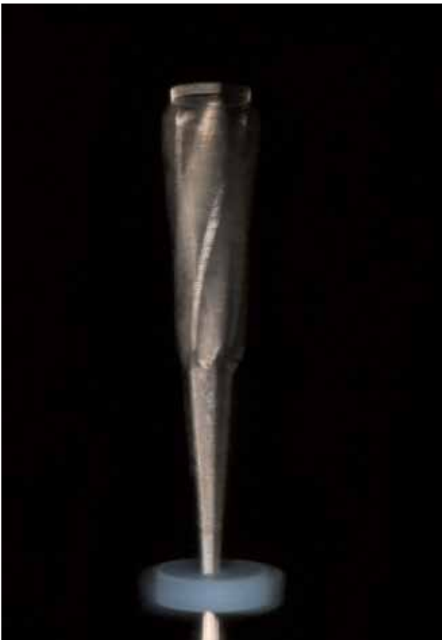
FIGURA 1G Cuando hacemos girar una fresa Peeso que tiene el vástago doblado, la punta oscila haciendo movimientos circunferenciales.
